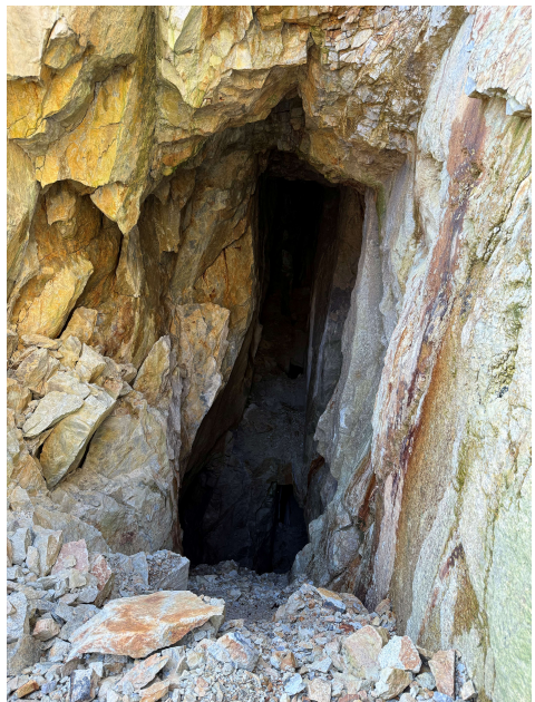
Fig. 5. Conxunto de galerías seguindo os filóns mineralizados. En detalle unha galería na canteira da mina.
