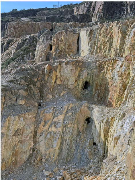
Fig. 5. Conxunto de galerías seguindo os filóns mineralizados. En detalle unha galería na canteira da mina.
